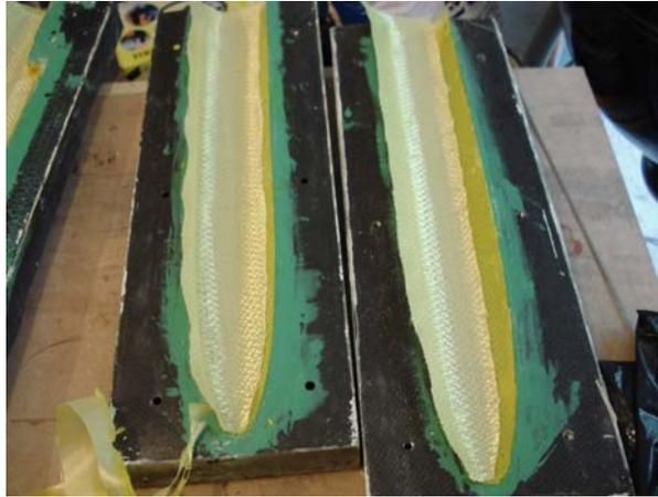
*Pose de la dernière lai de façon décalée. Etre précis afin que chaque lai aille rejoindre l'autre sans chevauchement une fois le moule fermé.*
