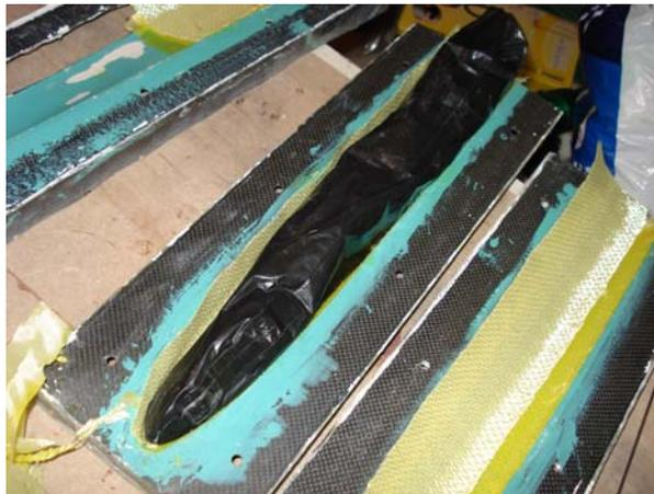
*Sac déposé dans le moule du support de coiffe. Ne faite pas comme ici : Plier le pour laisser la place au lai du moule adjacent.*
