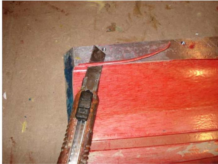
*Arasage d'une partie du B.A. dépassant. Attention à ne pas gratter la pellicule de démoulant sur le plan de joint. Normalement vous ne devriez pas avoir à réaliser une telle opération.*
