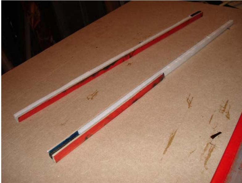
*Longeron light. Sur une aile complète,, le gain de poids est plus de 100gr entre une version lourde et celle light. Il y a bien un léger écart de résistance, mais pour une version électrique, il ne faut pas hésiter.*
