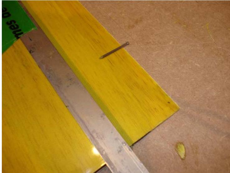
*Marquage de la charnière avec le dos d'une lame de cutter pour gratter la résine sans déchirer le tissu d'articulation.*
