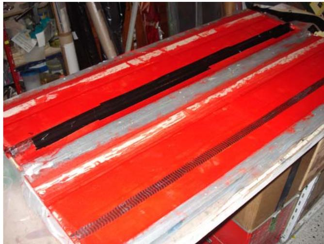
*Stratification du longeron avec les lais d'extrados. Un gain de poids certain pour une résistance identique. Vous noterez la longue bande de scotch le long du longeron pour permettre de bien plaquer le sac autour de ce dernier (le sac utilisé est un peu trop petit).*
