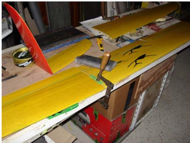
*Polymérisation de la clé d'aile entre le panneau central et l'aile droite. Le serre-joint n'est pas serré afin d'immobiliser sans marquer. Si cette opération était effectuée dans les moules à l'aide des gabarits d'implanture, les ailes deviendraient interchangeables entre elles. Ce n'est pas le cas ici.*
