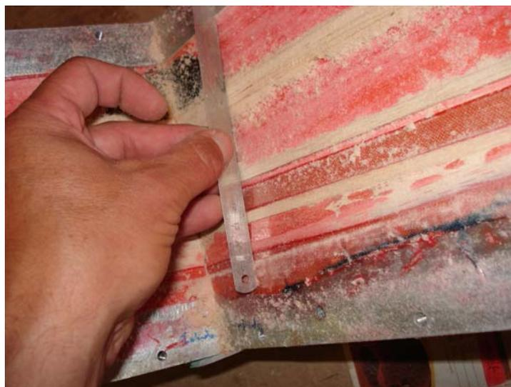
*Ponçage des longerons dans les berceaux. Vérifier avec un réglet le résultat.*
