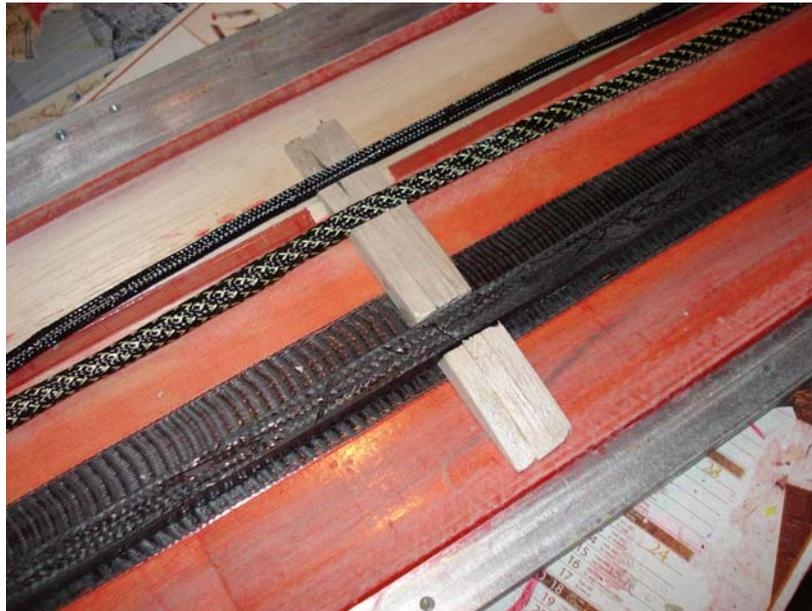
*Renfort pour la fixation de l'aile sous forme de balsa plein. Remarquez qu'un des rubans unidirectionnels a été placé en arrière du longeron. Cela imposera d'implanter le point de fixation et le passage des câbles des servos en arrière de ce ruban. Il aurait peut être mieux valu le mettre en avant du longeron...*
