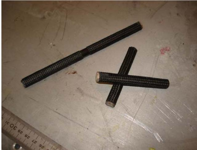
*Fourreaux et clé d'aile avant mise en place dans les ailes.*
