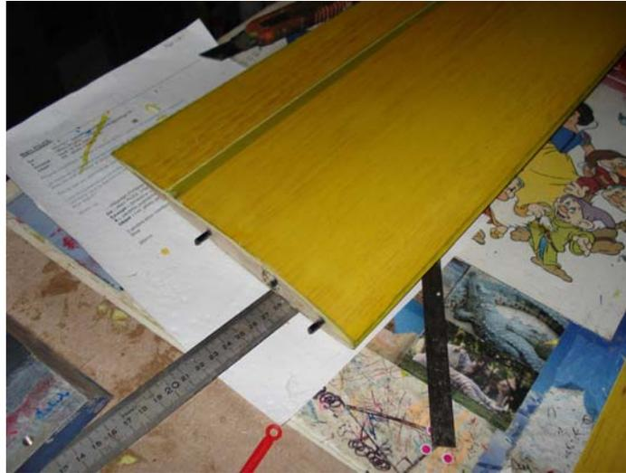
*Implantation des tétons de positionnement des ailes à partir des gabarits d'implanture. Cette opération doit se faire avant le démoulage de l'aile pour une bonne précision.*
