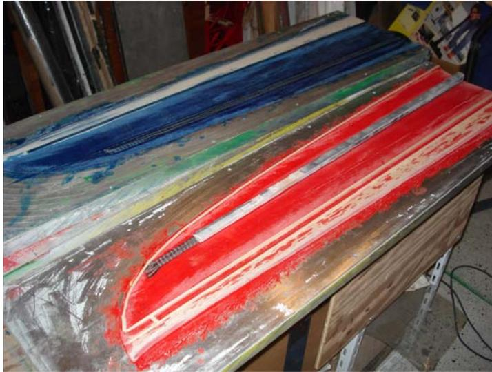
*Longerons arrières faits en Balsa. Pour parfaire leur hauteur, un petit coup de ponçage est bien pratique. Ils sont collés sur l'extrados à la cyanoacrylate. Remarquez au bord d'attaque une baguette de balsa tendre permettra de réduire le volume de micro-ballon à la jointure des deux moules tout en le renforçant. Remarquez aussi que les champs des gouvernes sont fermés (pour réduire les bruits aérodynamiques).*
